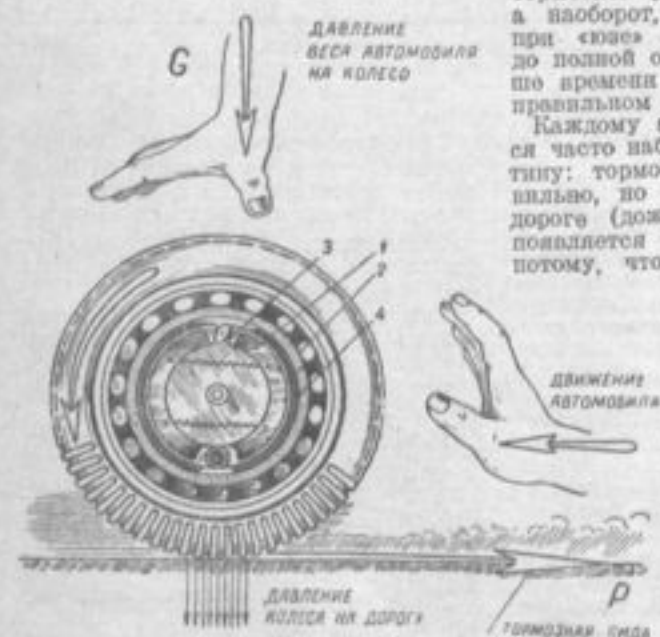
Рис. 1. Силы, действующие на колесо автомобиля в момент торможения
